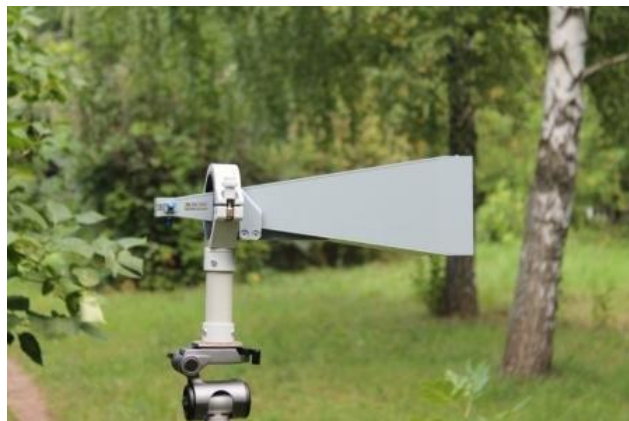
Фото1. Антенна П6-129 на штативе, вид сбоку
