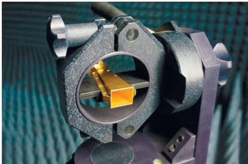
Измерительная рупорная антенна П6-135 предназначена для приема и передачи линейно поляризованного сигнала в диапазоне от 75 до 110 ГГц. Конструктивно выполнена по схеме «оптимального» рупора и имеет волноводный выход прямоугольного сечения 2,54 x 1,27 мм (WR10). Имеет два базовых варианта комплектации П6-135-1 и П6-135-2 в соответствии с используемыми потребителем типовыми оконечными устройствами.
