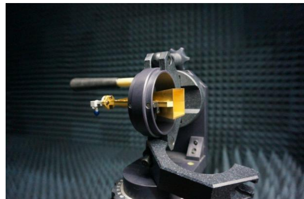
Фото 2. Антенна П6-134 на диэлектрическом штативе ШАД-01
