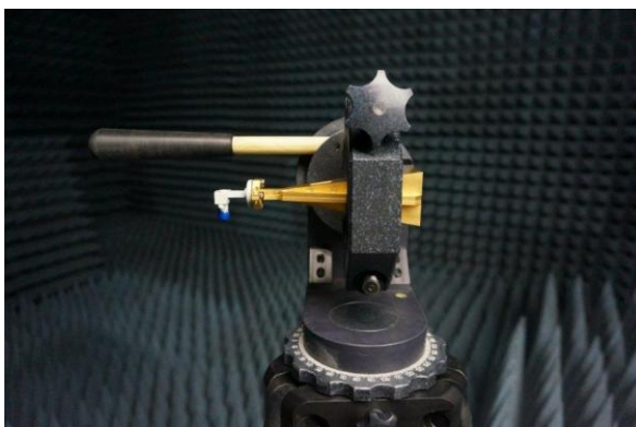
Фото 1. Антенна П6-134 на диэлектрическом штативе ШАД-01
