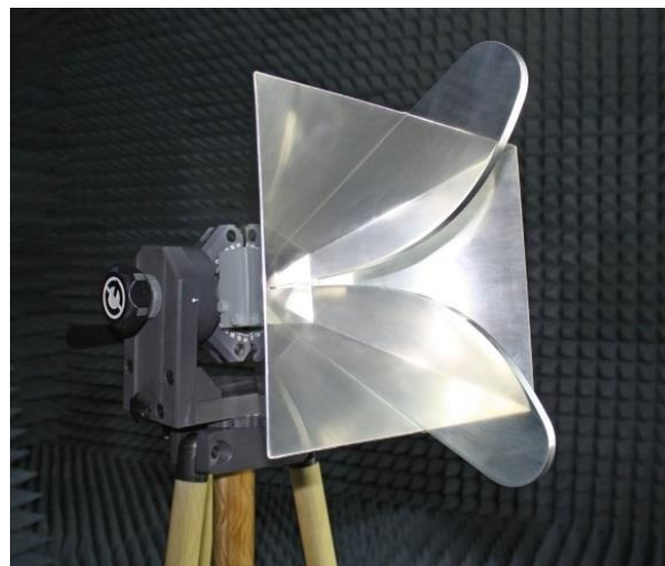
Фото 2. Антенна П6-223 на диэлектрическом штативе (ШАД-01)
