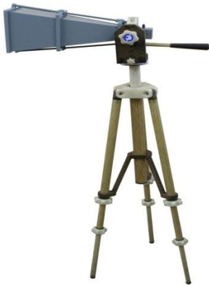
Фото 1. Антенна П6-125 на диэлектрическом штативе ШАД-01
