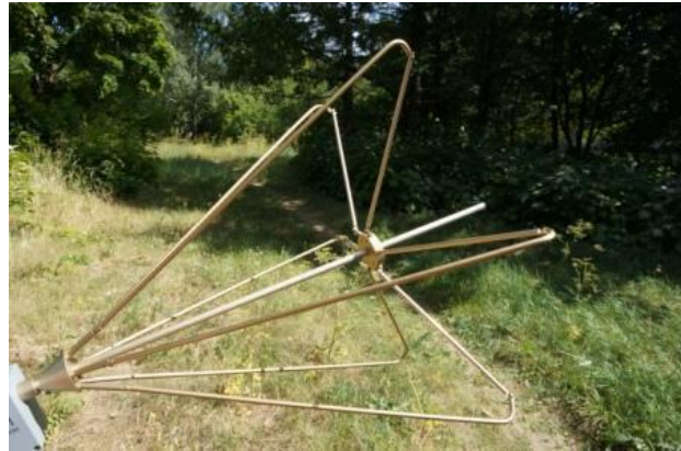
Фото 4. Антенна П6-121 на стадии сборки
