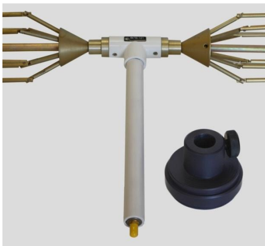
Фотографии 5 и 6. На примере антенны П6-121 с узлом крепления на диэлектрическом штативе (ШАД-01)
