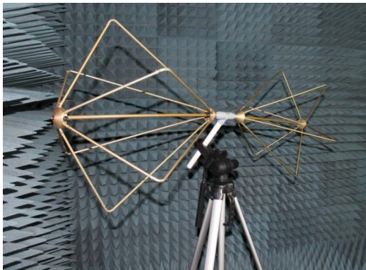
Фото 1. Антенна П6-121М1 на стандартном фотоштативе
