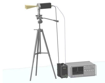
Рис. 4 Антенна П6-132 с преобразователем частоты СК5РТ 26-40/3-18 WR28
