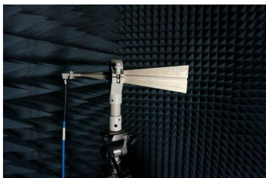
Фото 1. Антенна П6-131 на узле крепления АК-02М
