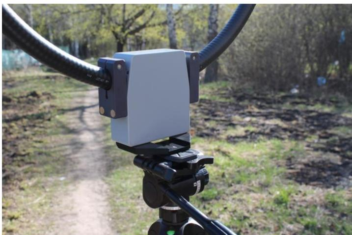
**Фото 3.** Вариант крепления антенны П6-119 на фотоштатив
