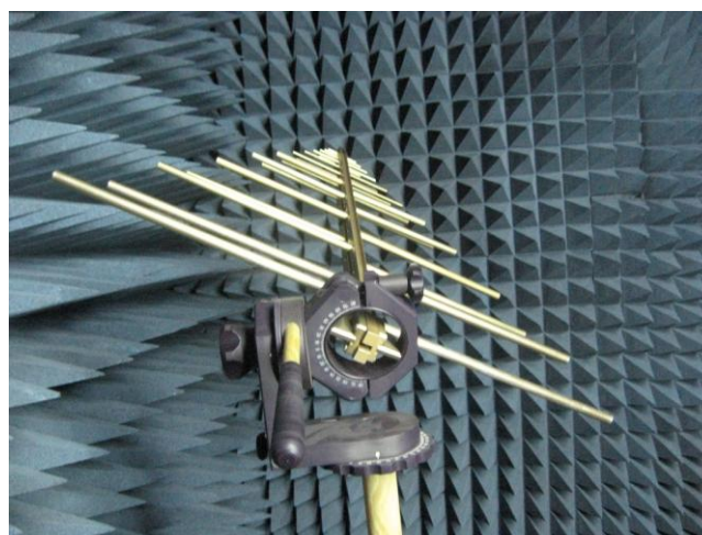
Фото2. Вариант крепления П6-122 на штатив
