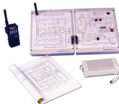
УКВ-трансивер диапазона 144МГц с частотной модуляцией
