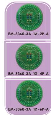
Имитатор обмоток асинхронного электродвигателя переменного тока EM-3360-3A может быть сконфигурирована для различных полюсов, таких как самозапускающийся трехфазный асинхронный двигатель и однофазный асинхронный двигатель, который используется при пуске резистора или конденсатора.
