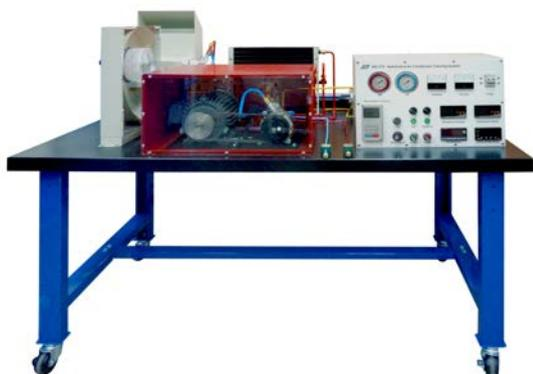
Структура KR-270 базируется на реальной автомобильной системе кондиционирования воздуха. Испаритель защищен акриловым пластиком, поэтому учащиеся могут наблюдать внутреннее строение испарителя. Учащиеся также могут безопасно наблюдать за тем, как во время работы системы дверца вентилятора переключает режим работы кондиционера с охлаждения на подогрев.
