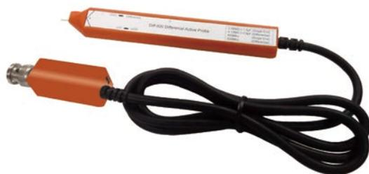
Активный дифференциальный щуп DF-600 — это щуп с высоким входным импедансом и малой входной емкостью, совместимый с осциллографом с входным сопротивлением 50 Ом и работающий в режимах дифференциального и однопроводного измерения. С помощью переключателя аттенюатора можно выбрать нужное ослабление.
