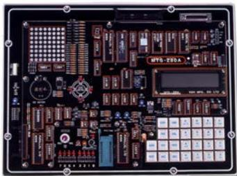
MTS-Z80A помогает студентам понять архитектуру и программирование Z-80 компьютера. Система состоит из пяти основных частей: (1) Z-80 процессор (2) системной и пользовательской памяти (3) набор микросхем мирового стандарта (4) устройства ввода и вывода, и (5) внешний интерфейс.
