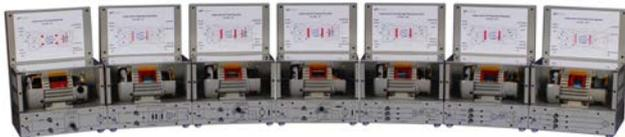
Модели в разрезе изготавливают из обычных электрических машин. Статор срезается по всей длине на  $\frac{1}{4}$ , при этом обеспечивается оптимальный обзор внутреннего строения машины, а статор остается рабочим. Разрезанные поверхности защищают от коррозии.
