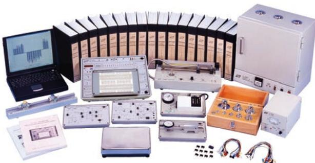
Сенсорная система на базе микропроцессора KL-600 представляет собой многостороннюю систему обучения с функцией управления датчиками-преобразователями, которые включает компоненты промышленного уровня с различными цепями управления и нагрузочными устройствами. Его модульные и замкнутые схемы управления позволяют реализовать отдельные контуры управления с открытым концом, используемые в промышленности.
