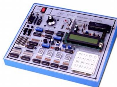
8051 - оригинальная микросхема семейства устройств MTS-51 производства компании "Intel". Это автономный мощный 8-разрядный микрокомпьютер, обычно используемый в приложениях контроля в реальном времени. Тренажер на микрокомпьютере MTS-51 предназначен для изучения архитектуры и команд микросхемы 8051.
