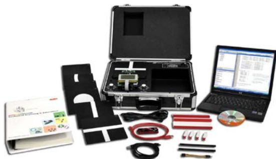
MTS-33T позволяет студентам выполнять 3 типа экспериментов с микромышью на лабораторном столе - это прохождение лабиринта со стенками, линейного лабиринта и прослеживание линий. Используя имеющиеся стены и стойки лабиринта, а также площадки, отслеживающие линии, студенты могут эффективно и гибко создавать условия для проведения соответствующего эксперимента.
