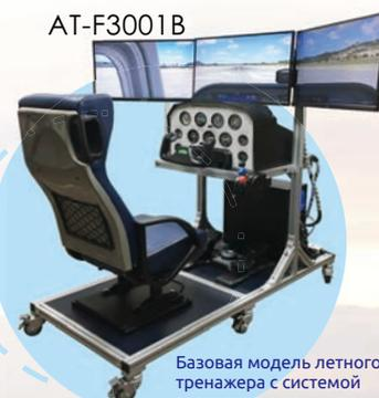
Базовая модель летного тренажера с системой визуализации
