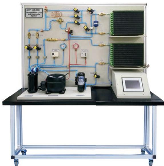
KR-115B предназначен для изучения теории теплопередачи в холодильной технике. В зависимости от настройки KR-115B может имитировать либо холодильную, либо теплонасосную установку. Все компоненты системы устанавливаются на передней панели, и студенты могут непосредственно наблюдать и трогать их, слышать, как они работают в цикле холодильной машины или теплового насоса.
