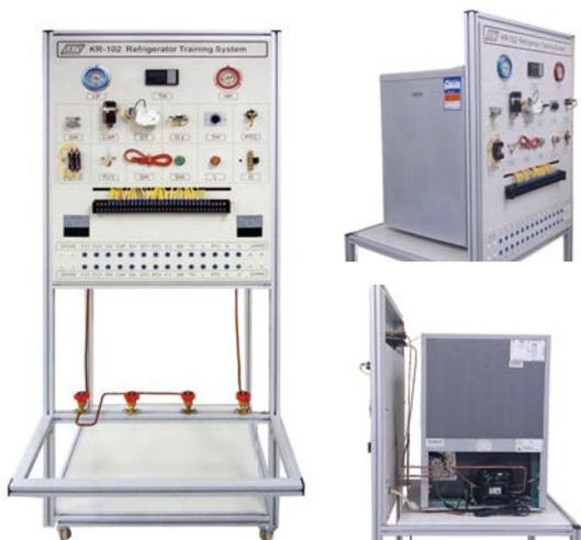
Назначение модуля KR-102 - дать учащимся представление о работе холодильной установки, а также навыки работы с ее схемой, сварки медной трубки и т.д. В этом модуле используется реальный вариант холодильника со специально установленными безопасными штепсельными разъемами. Для удобства выполнения упражнений по процессам сварки и охлаждения в модуле имеются три ручных клапана низкого и один высокого давления.
