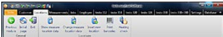
Модули Просмотр данных места измерений (Show measure location data), Изменение данных места измерений (Change measure location data), Добавление нового места измерений (Insert new location) и Печать штрих-кодов (Print barcodes) открываются с помощью функции Места измерений (Locations).
