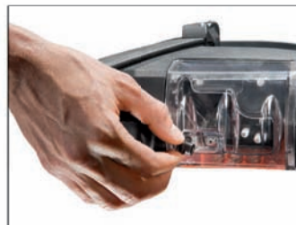
Режим непрерывной откачки конденсата для продолжительных измерений
