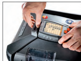
Управляющий модуль просто "защелкивается" в блок анализатора
