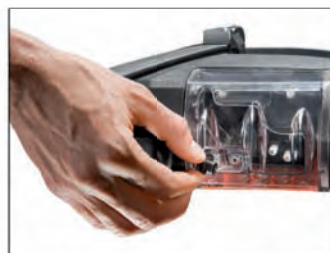
Режим непрерывной откачки конденсата для продолжительных измерений
