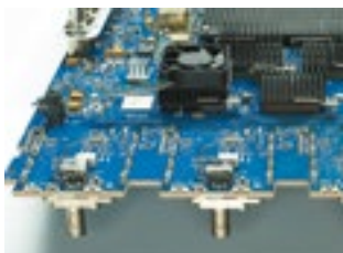
Малолушмящие входные каскады и корректирующие фильтры обеспечивают равномерную частотную характеристику
