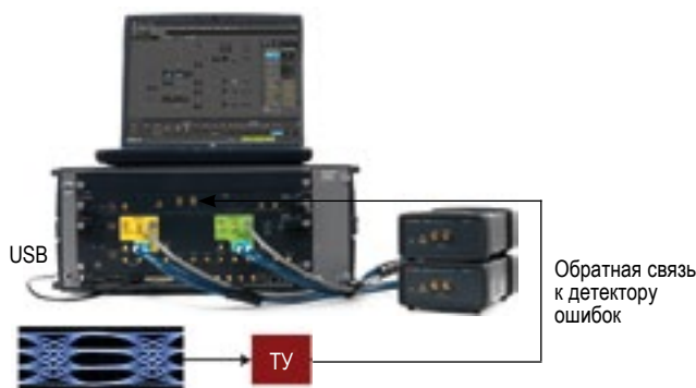
Сигналы PAM-4 и NRZ; 1- или 2-канальный генератор кодовых последовательностей с выносными головками, коррекция предскажений и внесение джиттера
