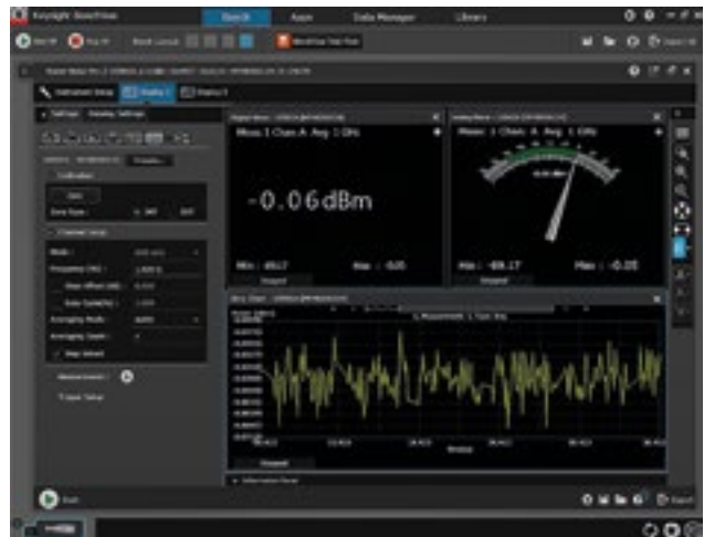
Форматы представления результатов измерения на экране: цифровой измеритель, аналоговый измеритель и регистратор данных.
