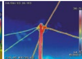
Снимок U5855A, который также использует матрицу 160x120, но обеспечивает разрешение до 320x240 благодаря технологии Fine Resolution
