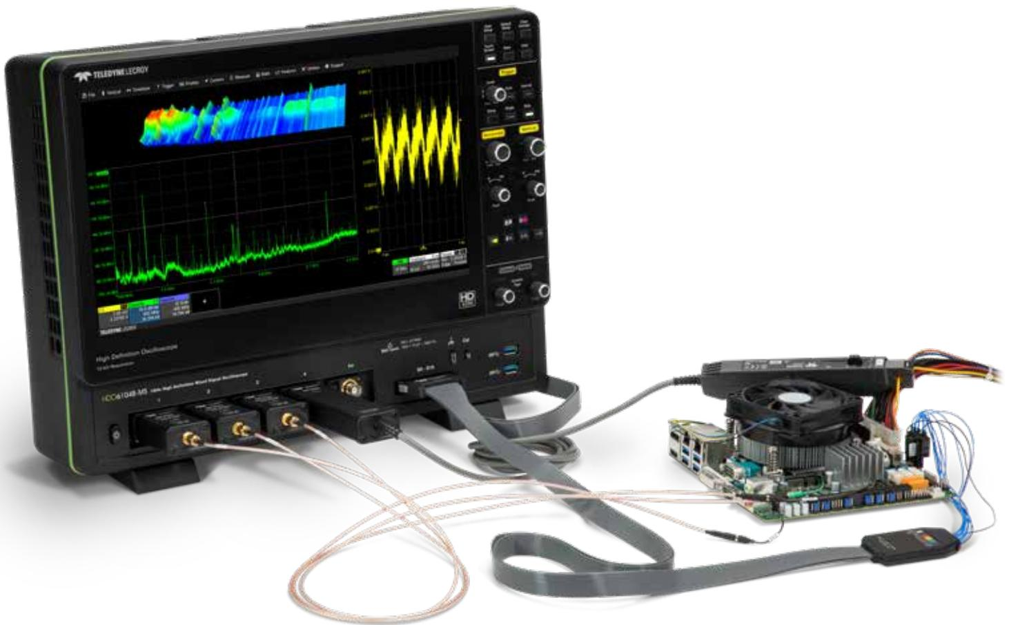
**Осциллографы высокого разрешения серии HDO6000BR с АЦП 12 бит с большой памятью позволяют выполнять проверку и отладку систем электропитания, как на уровне источника мощности, так и на уровне потребителя.**
