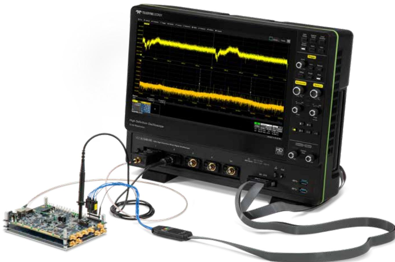
**Осциллографы высокого разрешения серии HDO6000BR с АЦП 12 бит и большой памятью позволяют выполнять длительный захват данных с высоким разрешением для глубокого тестирования встраиваемых вычислительных систем (аналоговых, цифровых, последовательных данных и датчиков).**
