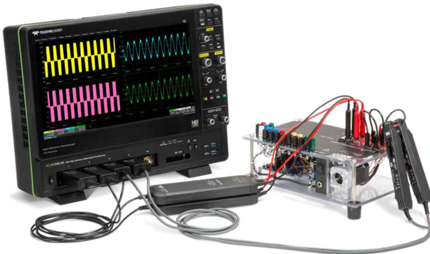
**12-битные осциллографы серии HDO6000BR имеют 4 аналоговых канала, что дает возможность выполнять анализ инверторов, систем питания и управления при использовании программной опции анализа мощности в 3-фазных сетях и опциональных высокопроизводительных пробников.**
