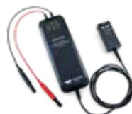
Серия высоковольтных диф. пробников HVD3000A, которые обеспечивают измерения напряжений в цепях, не имеющих общей точки. Идеально подходят для безопасных и простых измерений электрической мощности в различной силовой электронике. Благодаря высокому коэф. ослабления синфазных помех (CMRR) в сочетании с низким уровнем собственного шума и большим диапазоном смещения пробники HVD3000A наиболее оптимальны для анализа сигналов малых уровней в однофазных и 3-х фазных цепях.
