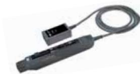
Токовые пробники с частотным диапазоном 100 МГц и измеряемый ток до 700 Апик., чувствительность преобразователя от 1 мА/Дел. Использование сразу нескольких токовых пробников позволит выполнять измерения 3-х фазных систем, или при подключении пробника напряжения измерять электрическую мощность. DCS025 – устройство калибровки для токовых пробников.
