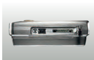
Разъем для подключения Мини-USB кабеля и SD-карты
