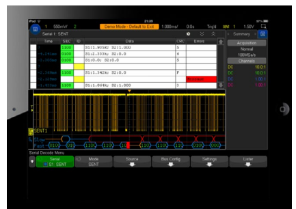
Рисунок 7: Боковая панель с возможностью размещения полей позволяет настраивать отображение результатов измерений по вашему желанию.
