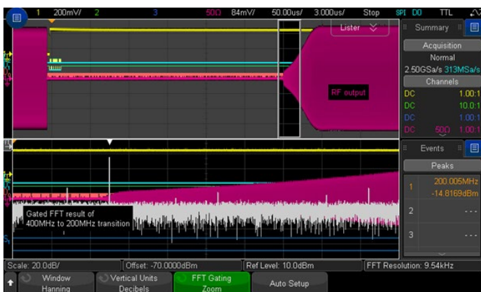
Рисунок 21c: Начало наблюдения сигнала при 200 МГц. Вы также можете проверить это на основе осциллограммы аналогового РЧ-сигнала.
