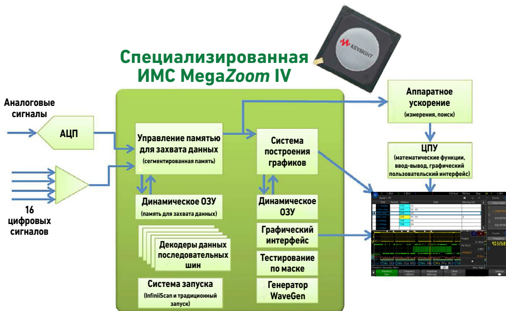
Рисунок 11. Быстрый отклик и высокая скорость обновления сигналов на экране в осциллографах 3000T серии X обеспечиваются специализированной ИМС интеллектуальной памяти MegaZoom IV. Для основных функций обработки сигналов ЦПУ не используется.
