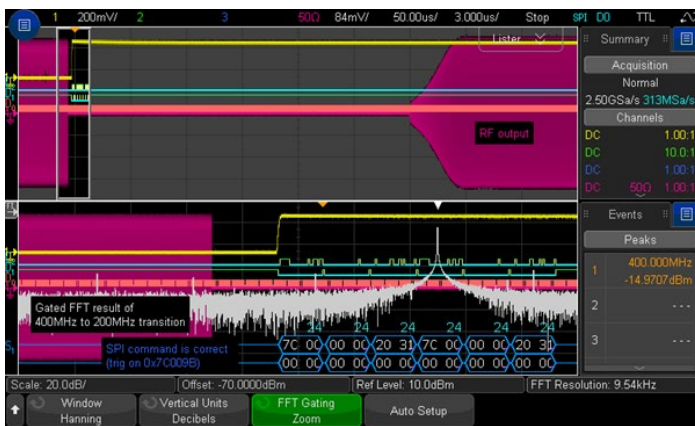
Рисунок 21a: При запуске по команде SPI частота РЧ-сигнала равна 400 МГц, на что указывает результат поиска пика частоты в списке.
