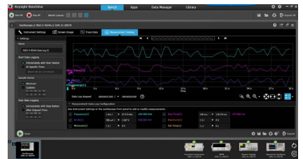
Рисунок 4: Используйте ПО BenchVue для удаленного ведения журналов и построения графиков измеренных данных.
