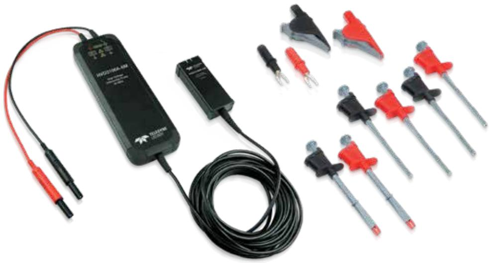
Высокочастотные дифференциальные пробники серии HVD3000A обеспечивают высокий CMRR (коэффициент подавления синфазного сигнала) в широком диапазоне частот, чтобы упростить задачи измерения, в шумных средах силовой электроники.
