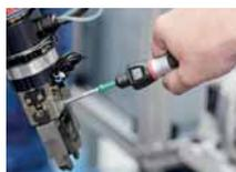
Динамометрическая отвёртка iTorque с цифровой шкалой
