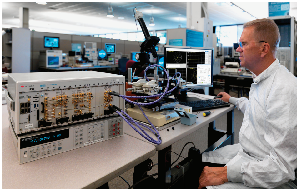
Тестирование усилителя мощности при помощи векторного анализатора цепей M937xA в формате PXIe, векторного генератора сигналов M9381A в формате PXIe и векторного анализатора сигналов M9391A в формате PXIe, а также измерительных программных приложений
