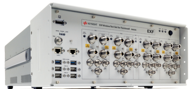
Измерительный комплект EXF для тестирования фемтосот от Keysight
