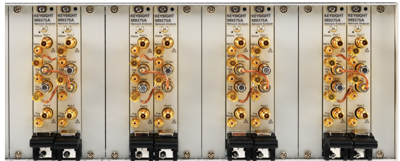
Рис. 3: Этот пример одновременного тестирования нескольких конфигураций включает в себя четыре независимых 4-портовых векторных анализаторов цепей в формате PXI в одном шасси
