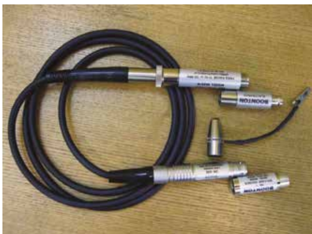
Измерительный зонд 952001 (диапазон частот от 10 кГц до 1,2 ГГц)
