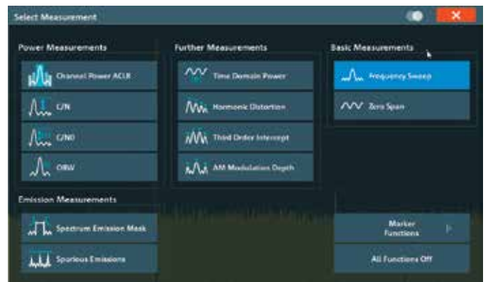
Множество предустановленных измерений: быстрый и простой доступ к обширному набору измерительных и маркерных функций в базовой модели, включая измерение спектрограмм и анализ I/Q-сигналов. Быстрая настройка с помощью понятных меню и функций сенсорного экрана.
