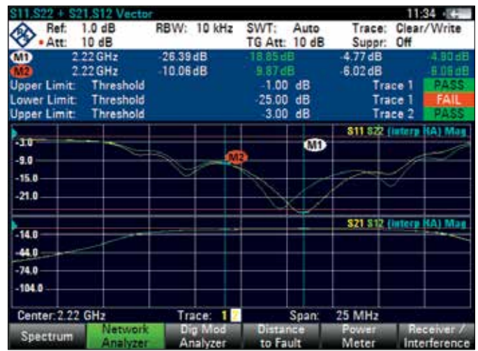
Режим векторного анализатора цепей: для тестирования и снятия характеристик антенн и потерь в кабеле, а также измерений расстояния до места повреждения. Поддержка двуportовых измерений передаточных характеристик.
