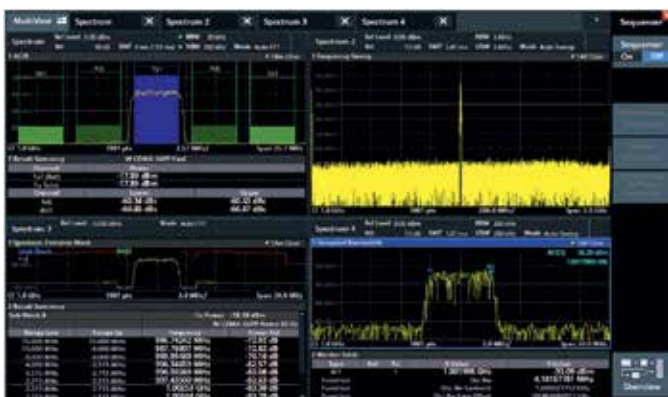
Гибкий пользовательский интерфейс: настройте окна результатов желаемым образом. Одновременно отображайте разные каналы измерения. Последовательное обновление канала допускает параллельное измерение, например спектра, спектрограммы, анализа I/Q-сигналов и аналоговую демодуляцию.
