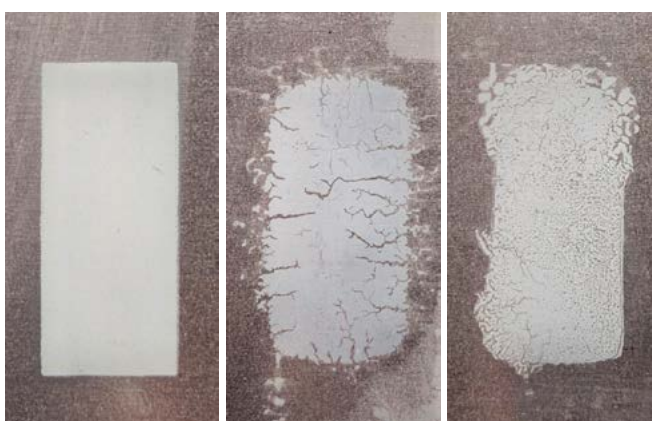
Фотографии, показывающие различие в характеристиках после испытаний термоударом в диапазоне -40...+125^{\circ}\text{C} .
