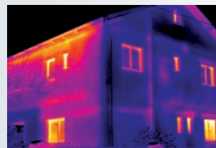
Выявление энергетических потерь в зданиях: Моментальное обнаружение и фиксация тепловых мостиков на фасадах или в ограждающих конструкциях зданий
