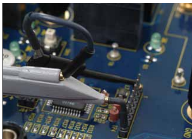
Изогнутый под 90° коннектор и подпружиненный крючок идеально подходят для подключения к штыревым выводам, разнесённым друг от друга.
