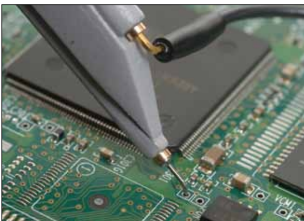
Подключение в труднодоступные места может быть обеспечено изогнутым наконечником и разного рода проводами заземления, как короткий гибкий изогнутый на 90° проводник.
