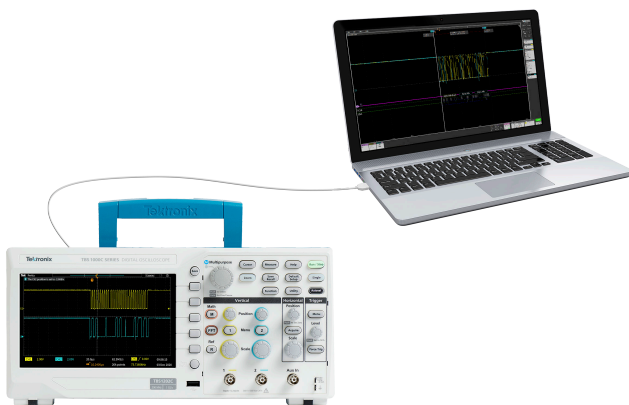
Рисунок 11. Анализ сигналов на ПК при помощи ПО TekScope
