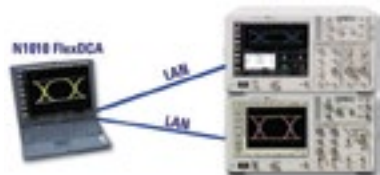
Выполнение измерений, происходящих в реальном масштабе времени, в режиме дистанционного управления через LAN
