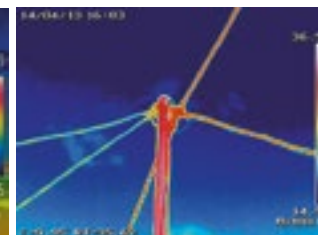
Снимок U5855A, который также использует матрицу 160x120, но обеспечивает разрешение до 320x240 благодаря технологии Fine Resolution
