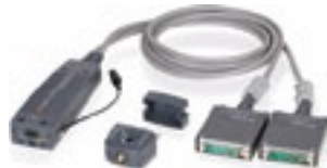
Двухканальный датчик тока CX1102A (поставляется с CX1203A)
