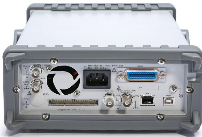
Внешний вид задней панели АКІП-3402
