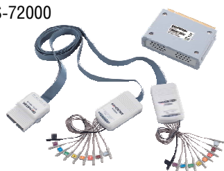
DS2-16LA Логический анализатор 16 каналов
