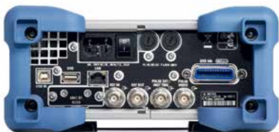
Универсальные возможности подключения: интеграция в текущую измерительную установку без необходимости изменения интерфейса подключения USB, Ethernet или GPIB.
