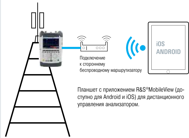
Дистанционное управление через LAN или USB: анализатор R&S®ZVH может как управляться дистанционно через интерфейс LAN или USB, так и интегрироваться в пользовательские программы.
