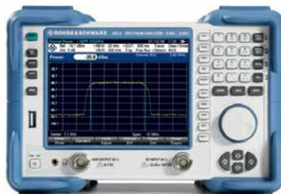
Следящий генератор для скалярных измерений параметров передачи.
