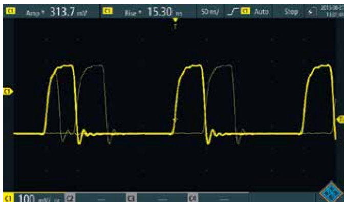
Высокоскоростная система сбора данных осциллографа R&S®Scope Rider захватывает до 50 000 осциллограмм/с, позволяя выявлять редкие и неожиданные аномалии сигнала.
