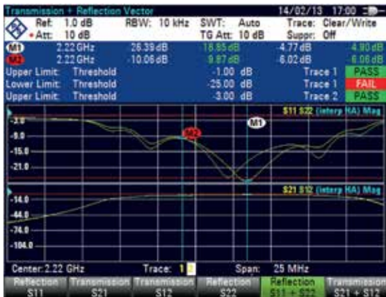
Векторный анализ цепей: одновременное отображение четырех S-параметров ( S_{11} , S_{21} , S_{12} , S_{22} ).
