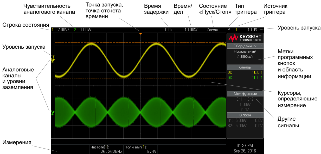
Рис. 1 Интерпретация показаний на экране осциллографа
