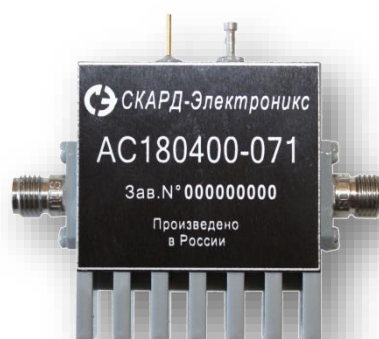
На фото: МШУ диапазона 18-40 ГГц с радиатором пассивного охлаждения
