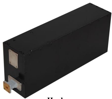
Малозумящий приемный конвертор СК2С.
