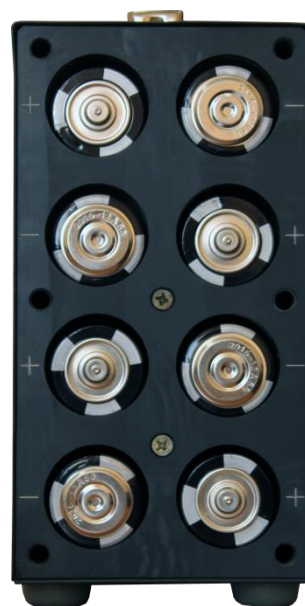
На фото 2: Батарейный отсек БНП-1 со снятой крышкой
