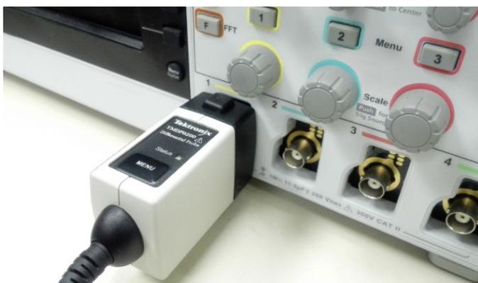
Интерфейс TekVPI осуществляет передачу информации о коэффициентах масштабирования, выбранных диапазонах и настройках между пробником и осциллографом TBS2000.
