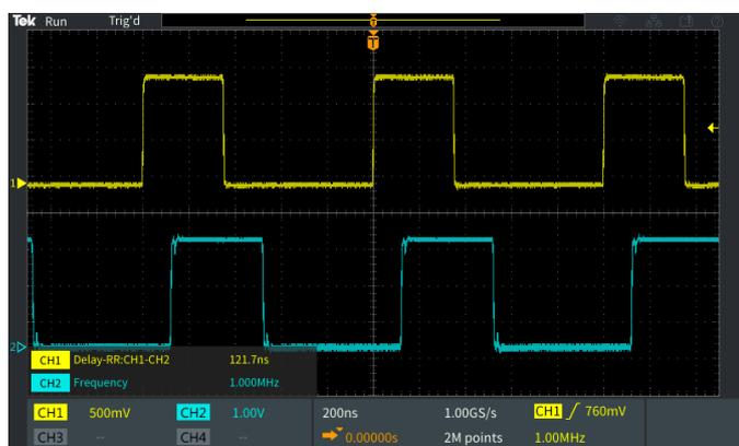
Измерения отображаются на прозрачном фоне, не закрывая осциллограммы.
