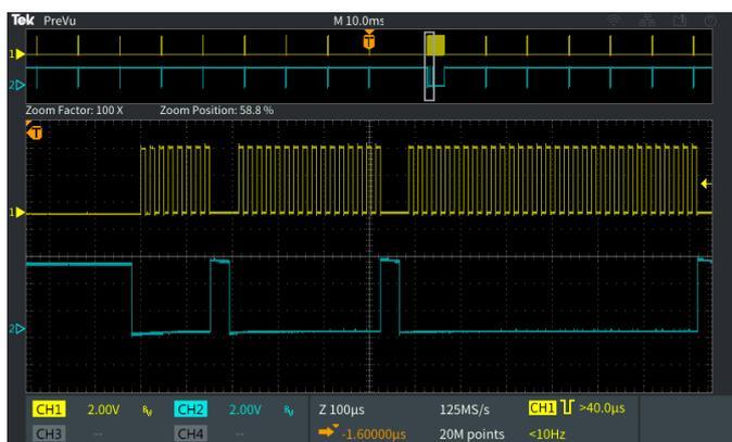
В режиме масштабирования в верхней части дисплея представляется запись сигнала длиной до 20 млн. точек. Ниже подробно отображается выбранный участок сигнала.
