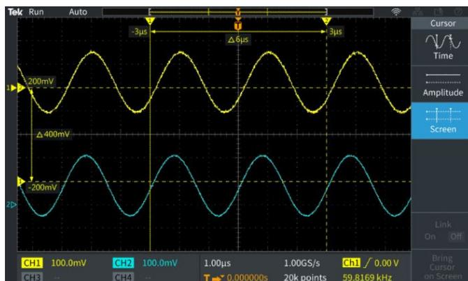
Данные курсоров отображаются непосредственно на осциллограмме. С помощью курсоров измеряют время и амплитуду.
