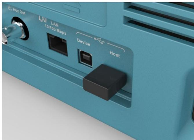
Адаптеры Wi-Fi, конфигурируемые с помощью встроенного меню, поддерживают непрерывную беспроводную связь
