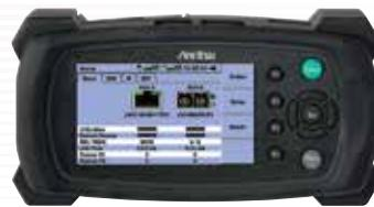
Портативный и простой в эксплуатации MU909060A имеет разнообразные измерительные функции для поддержки организации и обслуживания сетей Carrier Class Ethernet и мобильных транспортных сетей LTE.
