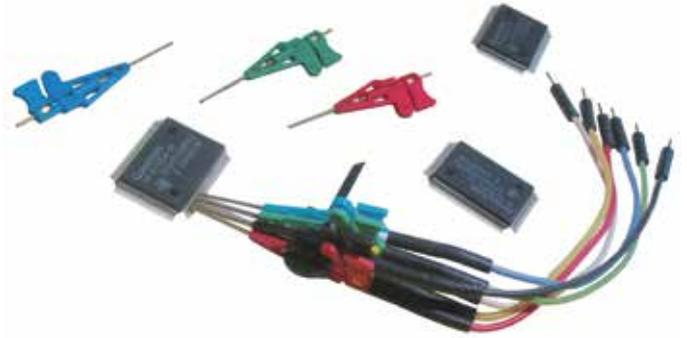
Подключайте микрозажимы от точки к точке на одной линии как показано на рисунке справа чтобы избежать соприкосновения контактов.
