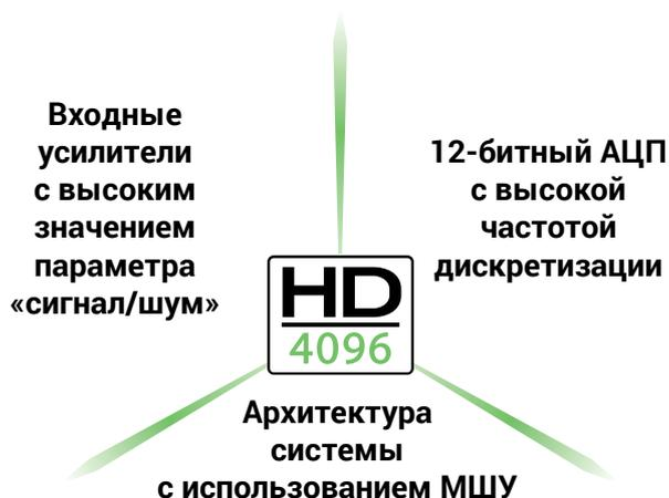
Технология высокого разрешения HD4096 основана на 12-битных АЦП с высокой частотой дискретизации, обеспечивающих лучшее соотношение сигнал-шум на входе усилителя и применение системной архитектуры с низким уровнем собственного шума. Это позволяет осциллографам WavePro HDR выполнять захват, сбор данных и отображение сигналов в полосе до 8 ГГц с высокой частотой дискретизацией и разрешением в 16 раз больше, чем другие типы осциллографов.
