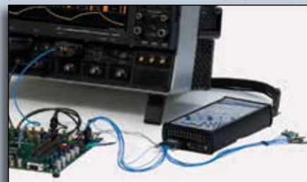
оболочку осциллографа. Кроме анализа логических состояний, MS-пробники используются для наблюдения низкоскоростных сигналов, таких как тактовая частота и последовательные данные, высвобождая аналоговые входы для ВЧ измерений.
