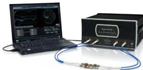
*SPARQ выполняет быстрее и проще все тесты на соответствие последовательной передачи данных, чем традиционные векторные анализаторы.*
