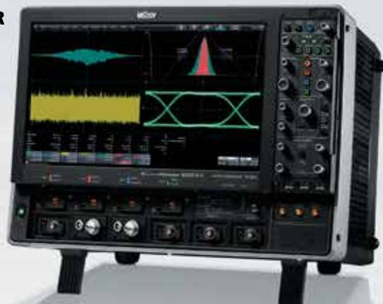
Все осциллографы серии WaveMaster 8 Zi-B-R реализованы на единой аппаратной платформе. Для расширения полосы пропускания свыше 20 ГГц компания TeledyneLeCroy использует технологию чередования полос пропускания (DBI). Для минимизации начальных затрат пользователя СВЧ модуль, который удваивает полосу пропускания,- это отдельное устройство, устанавливаемое в слот платформы WaveMaster 8 Zi-B-R
