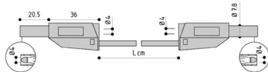
Безопасный соединительный кабель: проходной бантан 4 мм - проходной бантан 4 мм, контакты медно-бериллиевый сплав, изоляция - полипропилен. Изоляция кабеля ПВХ или силикон.
