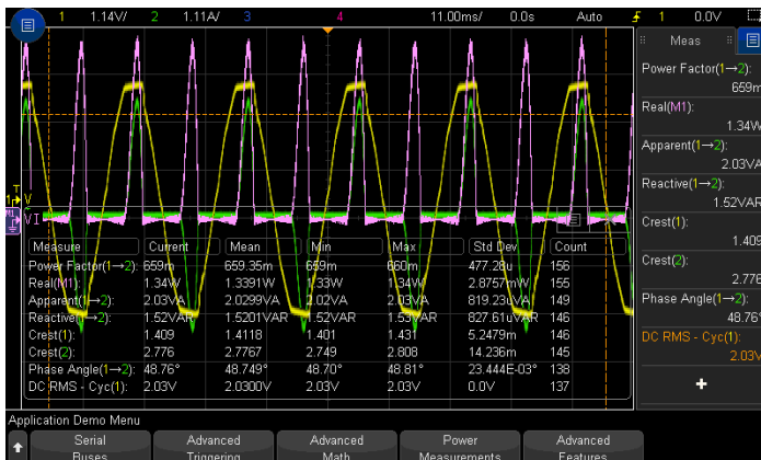
Рисунок 29: Встроенные измерения шин питания позволяют быстро выполнять анализ устройств, выдающих и запасующих энергию.
