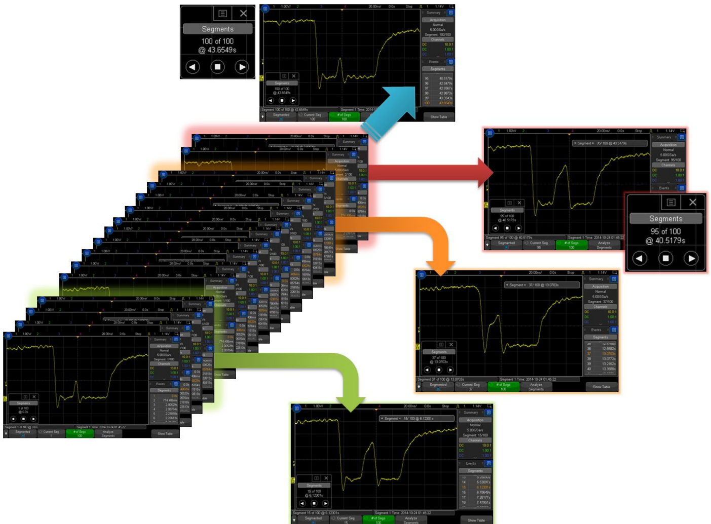
Рисунок 13: Сегментированная память позволяет обнаруживать возникающие выбросы различных типов.
