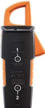
2. С помощью отвертки открутите два металлических винта (1, 2) на отсеке для батареи и снимите крышку отсека. Не извлекайте винты полностью.
